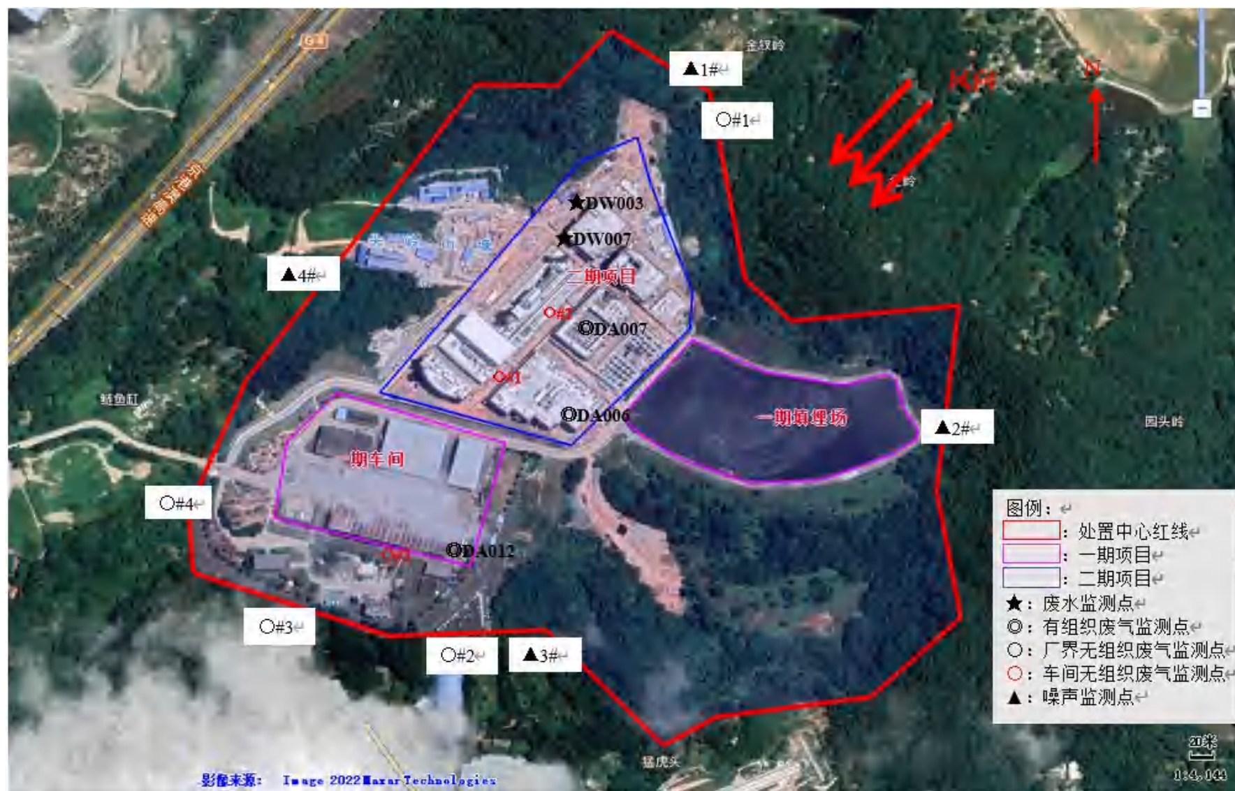
图8.3-1 废气、废水、噪声监测点位图
