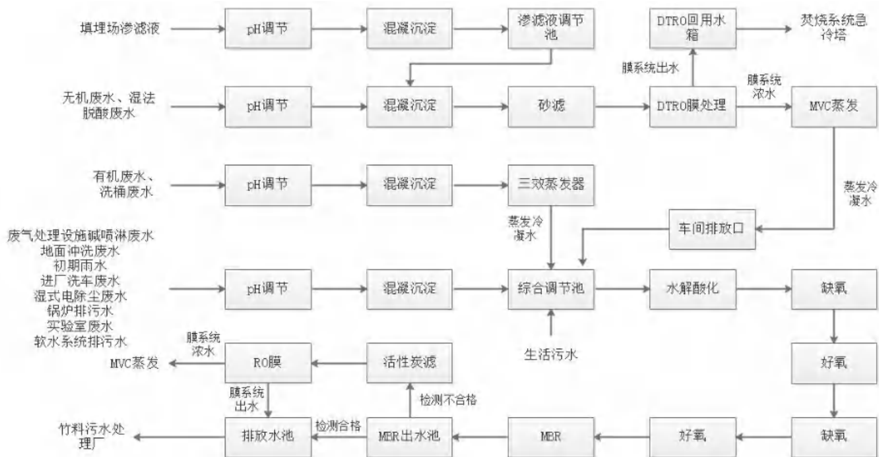
图4.2-7 现有项目废水处理措施总流程
