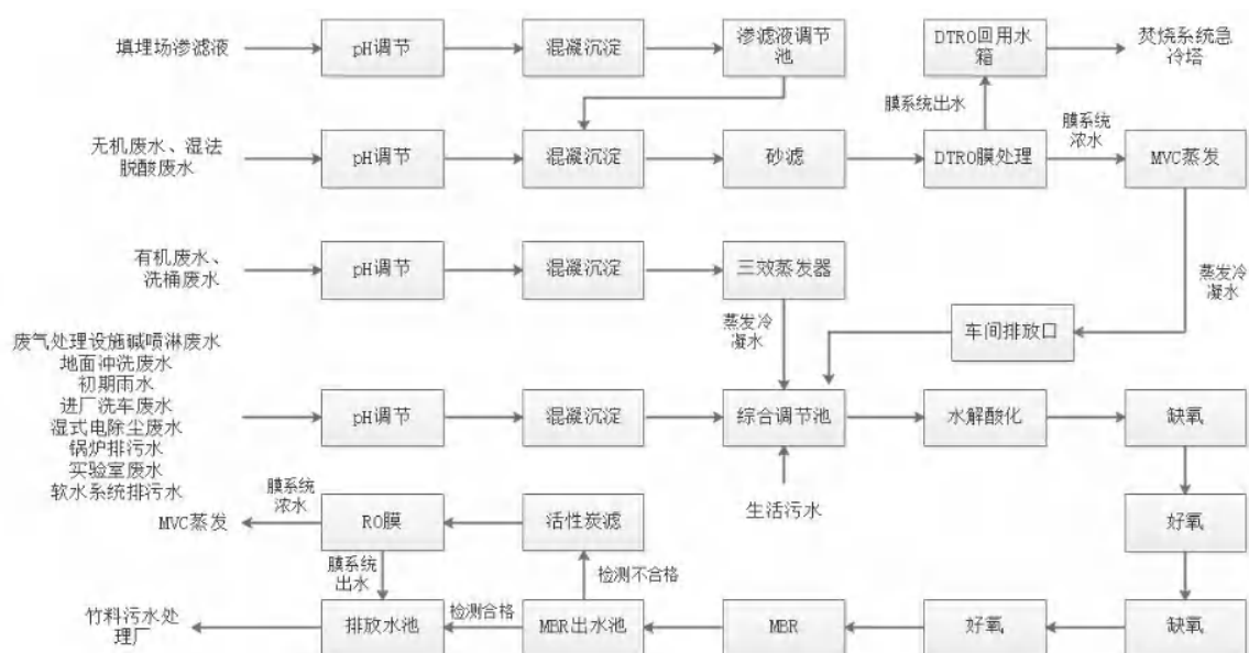
图5.1-1 废水处理工艺流程图
